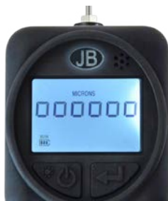
Presión atmosférica - Modo de funcionamiento normal
